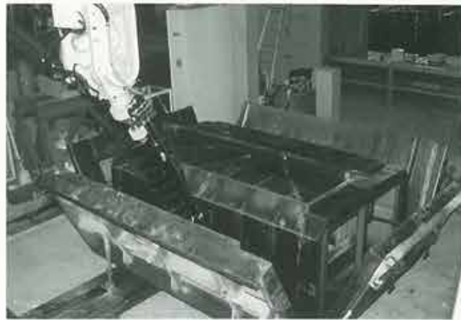
写真-5/型枠塗油ロボット
