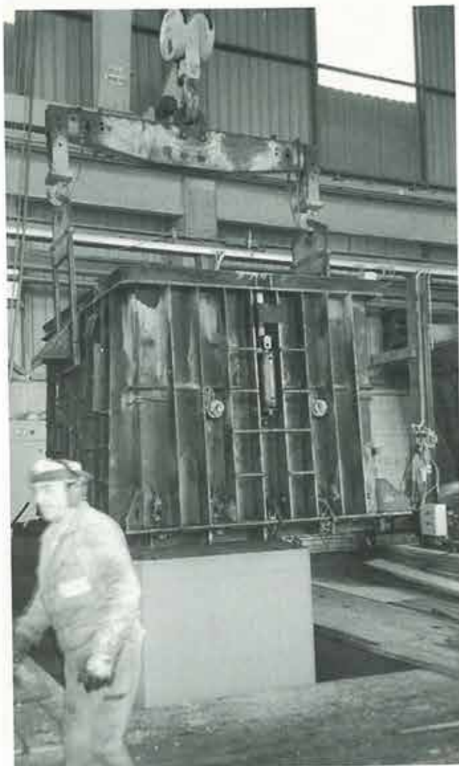
即脱ボックス製作状況
